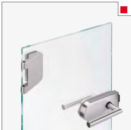
für 1-flügelige Türen aus Einscheiben-Sicherheitsglas (ESG), für Glasdicke: 8 mm, Abdeckung für Schloss Edelstahl, Bänder edelstahlfarben, Türgewicht: mit 3-teiligem Band ≤55 kg, DIN links und DIN rechts verwendbar, mit geräuschgedämpfter Falle
