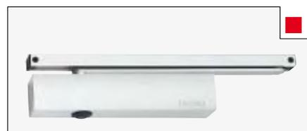
Für Feuer- und Rauchschutztüren geprüft. Für die Montage auf der Tür muss im Regelfall eine Montageplatte verwendet werden. Schließkraft, Schließgeschwindigkeit, Öffnungsdämpfung und Endschlag von vorne einstellbar
