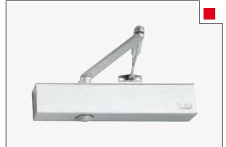
Für Feuer- und Rauchschutztüren geprüft. Schließkraft und Schließgeschwindigkeit stufenlos einstellbar, einstellbare, selbstregulierende Öffnungsdämpfung, Endschlag stufenlos über Gestänge einstellbar
