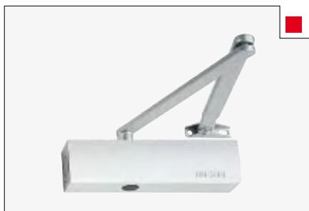
Schließkraftverstellung der Größen 2, 4 und 5 durch versetzte Montage, Schließgeschwindigkeit von vorne einstellbar, Schlageinstellung über Gestänge
